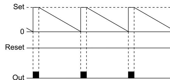
Reset işlemi, otomatik yapılır. Sayma, yukarı doğru iken set2 ye kadar devam eder ve output-2 aktif iken sayma durdurulur. Sayma, aşağı doğru iken 0 a kadar devam eder ve output-2 aktif olduğu sürece sayma durdurulur. Sayılan değer Output-2 pasif olduğunda sıfırlanır ve sayma devam eder. Output-1 pulse çıkışı veya sürekli olarak ayarlanabilir. Out2 pulse li çalışır. Output-1 aktif iken output-2 ile beraber pasif olur.
