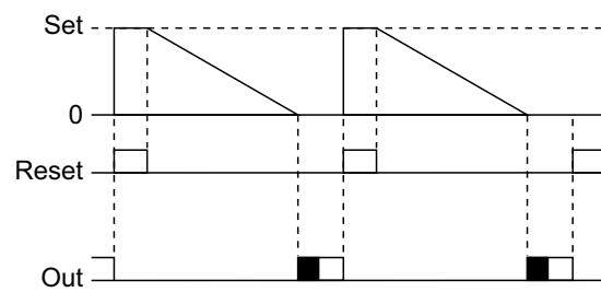
Reset işlemi, manual yapılır. Sayma, yukarı doğru iken set değerinde aşağı doğru iken 0 değerinde durur. Output pulse çıkışları veya sürekli olarak ayarlanabilir.
