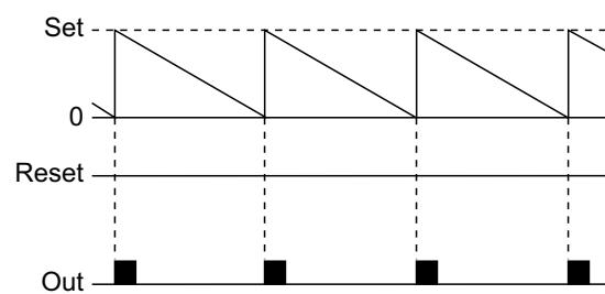
Reset işlemi, otomatik yapılır. Sayma, yukarı doğru iken set2 ye kadar devam eder, set2 ye ulaştığında sıfırlanır. Output-1 pulse çıkışları veya sürekli olarak ayarlanabilir. Out2 pulse li çalışır. Output-1 aktif iken output-2 ile beraber pasif olur.
