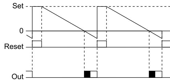
Reset işlemi, manual yapılır. Zaman sayma, reset işlemi gerçekleşinceye kadar devam eder. Output pulse çıkışları veya sürekli olarak ayarlanabilir.
